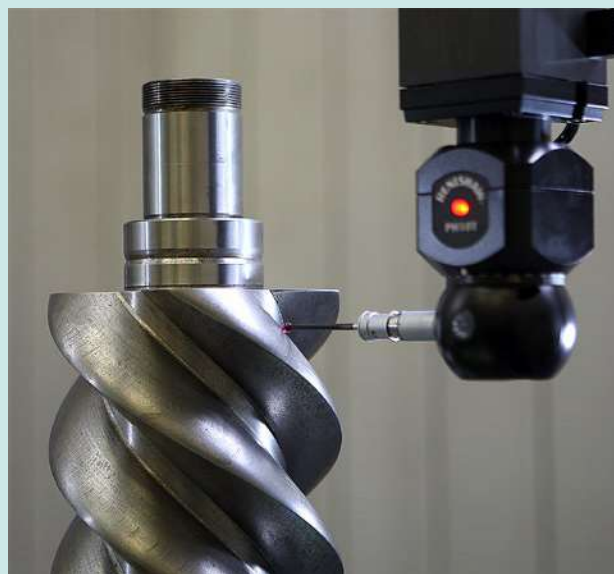
3D měření každého vyrobeného kusu
